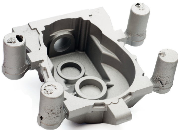
Rysunek 3: Obudowy przekładni z różnymi technologiami zasilania
