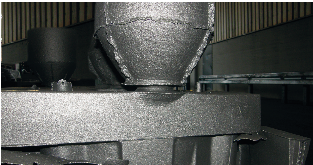
Rysunek 2: Rezultat uzyskany ze zredukowanym exo-iso zasilaczem z ZRF technologią CLEANCore®
