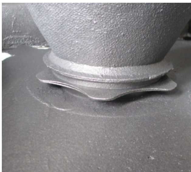
Rysunek 5: Pozostałość po zasilaczu po śrutowaniu
