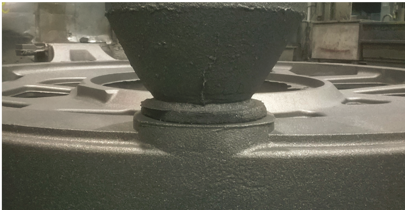
Rysunek 1: Rezultat uzyskany z konwencjonalnym cylindrycznym zasilaczem exo-iso z dodatkowym naddatkiem na obróbkę
